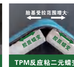
无蠕变卷材受拉断裂
